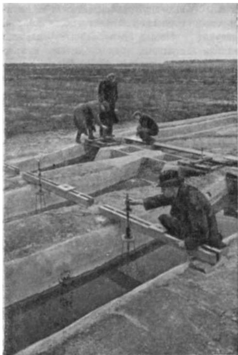
Научный сотрудник Института М. С. Гаража измеряет уровень воды на модели канала.
